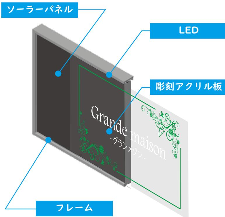
ソーラーパネルの受光面にアクリル彫刻板を重ね合わせた「独立式の発電構造」をもちます。生み出した電力で夜間にライトアップする LED サインです。
